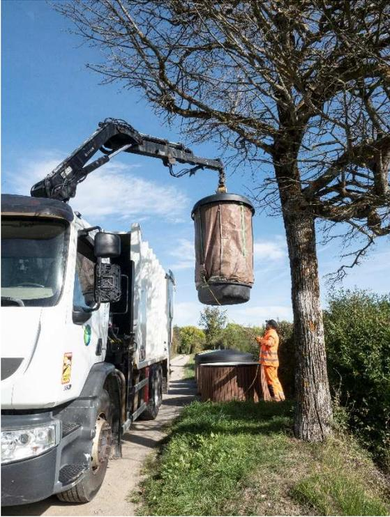
Les ordures ménagères sont collectées avec l'aide d'un camion à compaction équipé d'une grue.
